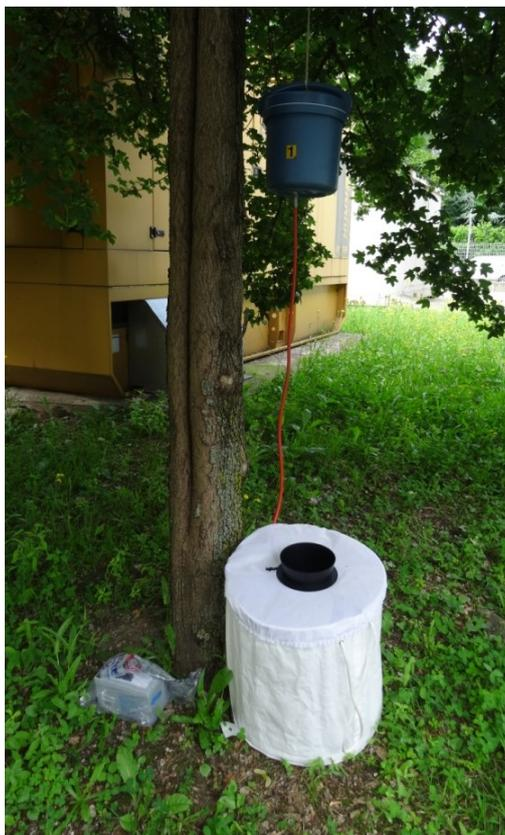
**Figura 18, trappola BG Sentinel per la cattura di zanzare adulte presso l'ospedale di Verbania (non visibile in foto, appeso all'albero viene posizionato un cartello plastificato a spiegare l'attività in corso).**
