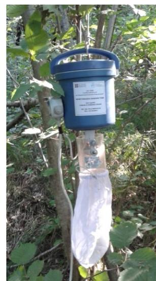
**Figura 8, trappola alla CO<sub>2</sub> per il monitoraggio delle zanzare adulte.**
